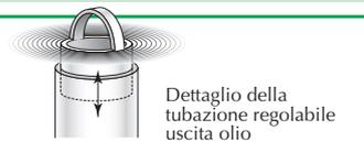
Dettaglio della tubazione regolabile uscita olio
